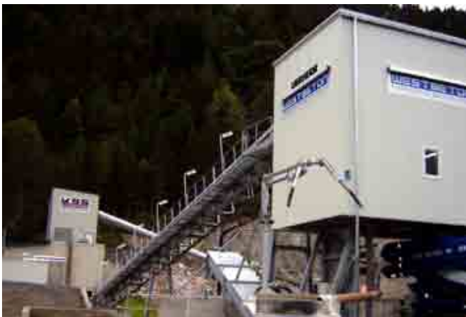
Durch den geschlossenen Materialtransport entsteht weniger Staub.
